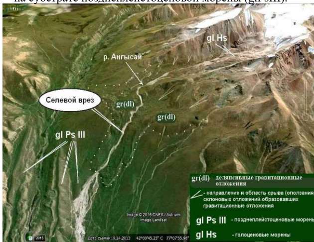
Рис. 3. Селевой очаг (селевой врез) в долине р. Ангы-Сай (бас. р. Тон, хр. Терской Ала-Тоо). Селевой врез – на субстрате псевдоморен в виде делясивных гравитационных отложений, обозначенных символом gr(dl). Транзит грязекаменных селевых потоков – более 20 км. Стрелками показаны область и направление срыва (оползания) полигенетических склоновых отложений, образовавших эти псевдоморены
