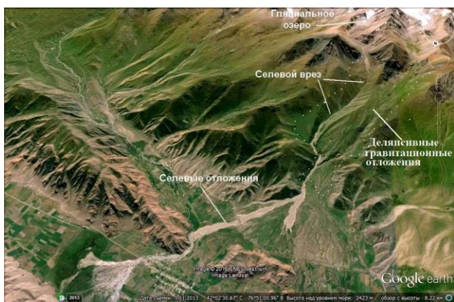
Рис. 5. Селеопасная долина р. Зындан (хр. Терсей АлаТоо). Протяженность транзитной зоны грязекаменного селевого потока – более 15 км. Селевой очаг (селевой врез) – на субстрате псевдоморен в виде делясивных гравитационных отложений (см. рис.6). Источником воды селевого потока явилось прорвавшееся небольшое ледниковое озеро
